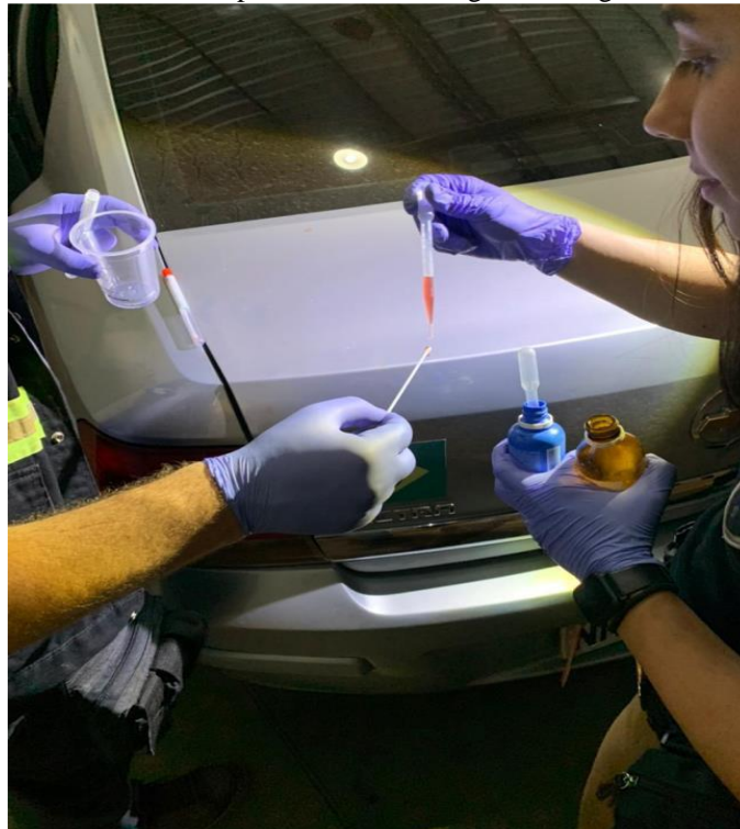
Imagem 15: Exame Pericial em veículo para encontrar vestígios de sangue – “Luminol e Kastle Meyer”.
