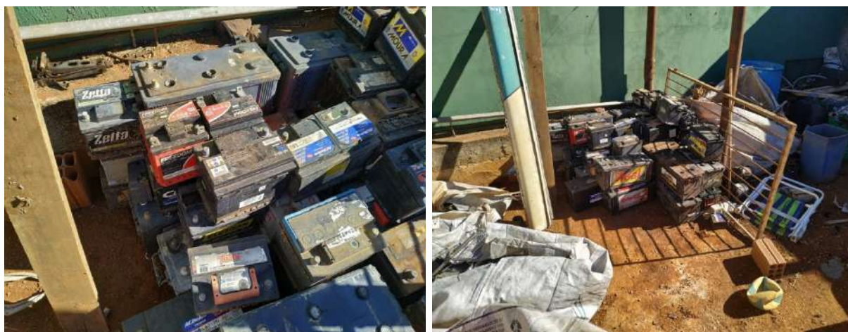
Figura 3 e 4 – Baterias Usadas armazenadas irregularmente.
